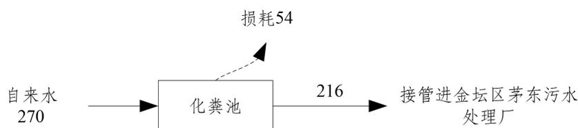
图 3.5-1 水平衡图 (t/a)
