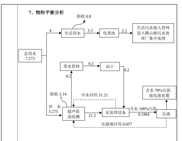
图 2-1 全厂水平衡图 (t/d)
