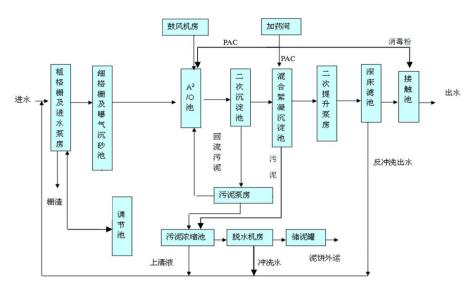
图 4-2: 污水厂处理工艺流程图
