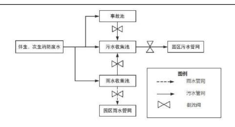
图4-6 事故排水控制和封堵示意图
