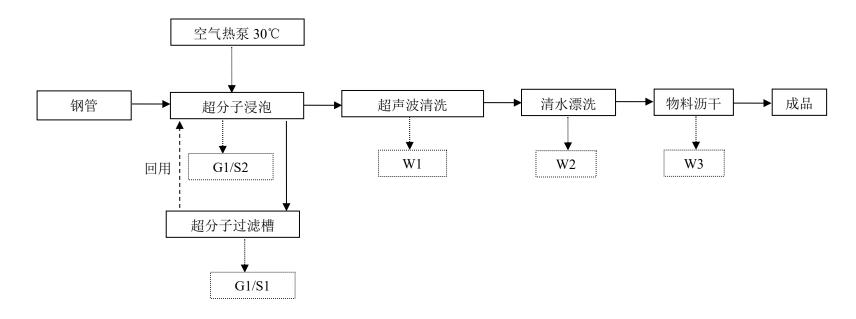
图 2-2 工艺流程及产污环节图
