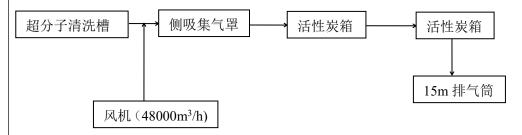
图4-1 废气收集处理系统图
