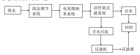
图 4-3: 电氧微纳米水处理工艺流程
