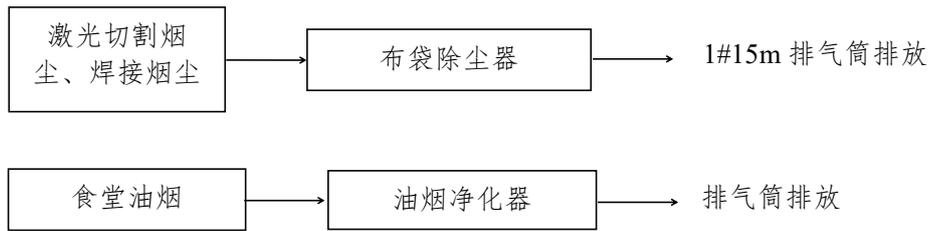
图 2-5 废气处理流程图
